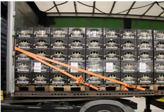
Abb. 3: Absicherung der Stirnwand
