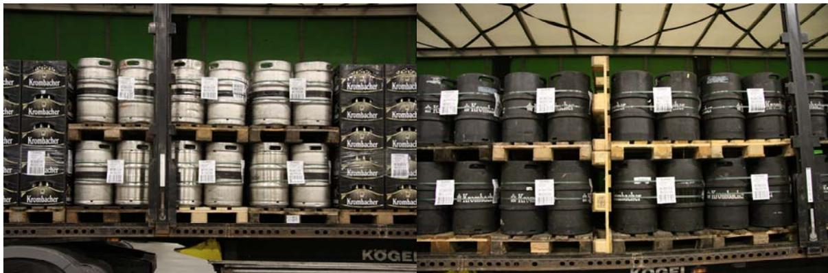
Abb. 1: Sinnvolle Anordnung für Mischladungen      Abb.2: Bei Fass-Vollausladungen können Paletten helfen (Bildung „formschlüssiger Gefache“ durch Kastenware für nicht mehr als 6 X 6 Stahlfässer in der Grundfläche)
