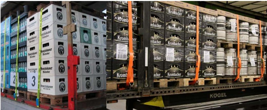
Abb. 4 & 5: Zur Stabilisierung und Zurrung sind Paletten oder geeignete Kantenschutzwinkel erforderlich. Aufgrund der Elastizität der Kunststoffkästen muss hierbei eine Holzpalette oder ein anderes Hilfsmittel zur Krafteinleitung des Zurrmittels in die Palette benutzt werden. Auch Fassladungen können derartig gesichert werden.
